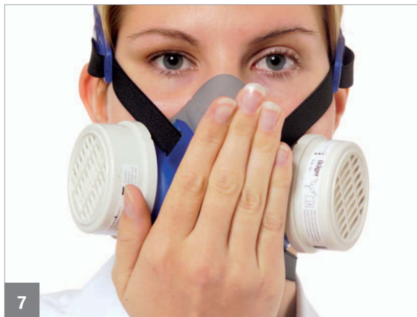
7 Überdruckprüfung: Ausatemventil dichthalten und einmal kräftig ausatmen. In der Maske baut sich kurzzeitig ein leichter Überdruck auf. Falls Luft über den Dichtrahmen abströmt, Maske zurechtrücken und Bebänderung nachziehen oder andere Größe verwenden. Prüfung wiederholen bis Maske dicht sitzt.
