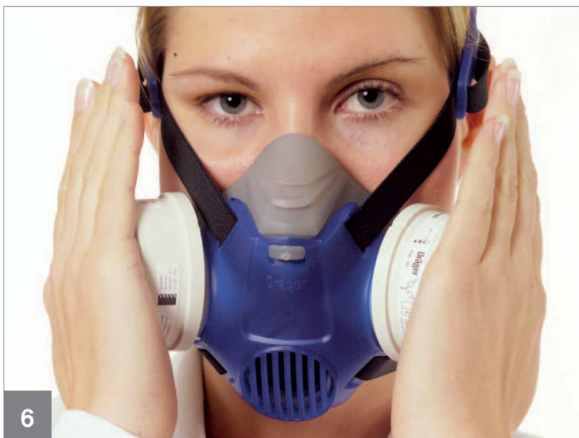
6 Unterdruckprüfung: Beide Filter mit den Händen dichthalten und einatmen, bis Unterdruck entsteht, Luft kurzzeitig anhalten. Der Unterdruck soll bestehen bleiben. Sonst Maske zurechtrücken und Bänder nachziehen oder andere Größe verwenden. Prüfung wiederholen bis Maske dicht sitzt.
