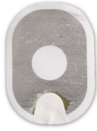
Abbildung 3: Gel fast vollständig von Folie abgelöst.
